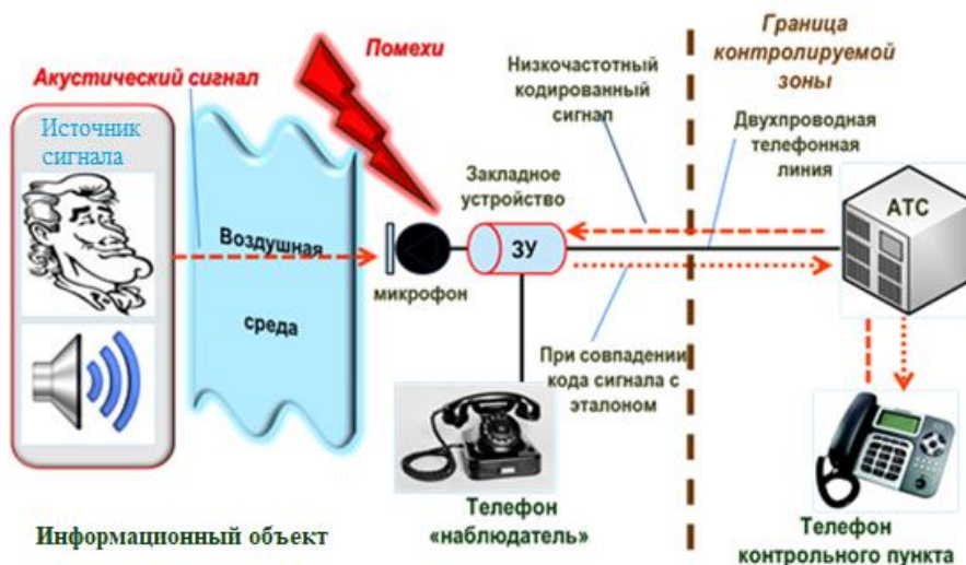
Рис 1. Структурная схема реализации способа перехвата речевой информации с использованием закладного устройства типа «телефонное ухо»
